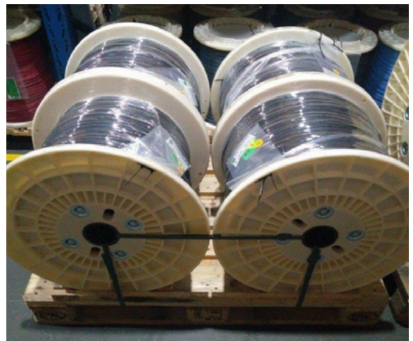
Abb. 8: Trommel stehend auf Flansch platzieren
