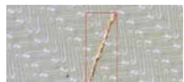
metallischer Partikel 421 \mu\text{m}
