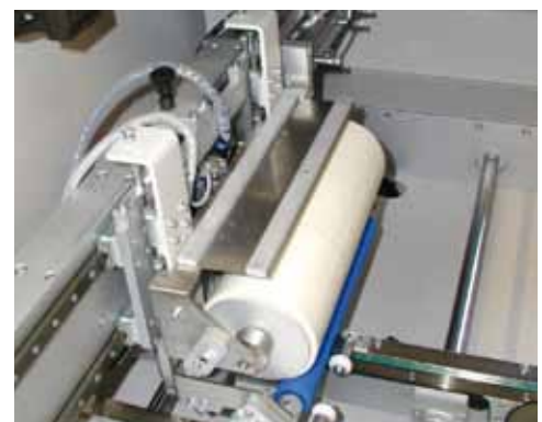
Abb. 86: Adhäsionsrolle für die Durchlaufreinigung von Leiterplatten
