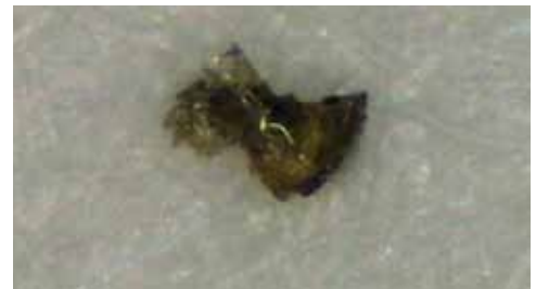
Abb. 35: Nichtmetallischer Partikel, vermutlich Verpackungsmaterial, rosa Schaumstoff'
