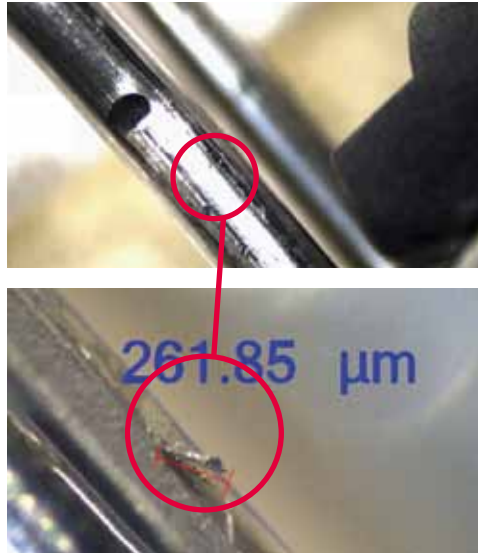
Abb. 27: Detaildarstellung mit Vermessung der Partikellänge
