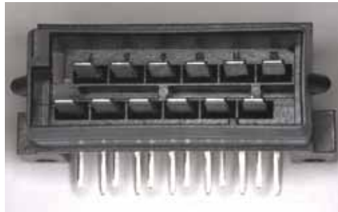
Abb. 52, 53: 12-poliger Stecker mit überbrückten Kontakten
