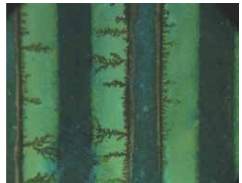
Abb. 104: Dendritenbildung zwischen einer Kammstruktur auf einer Leiterplatte
