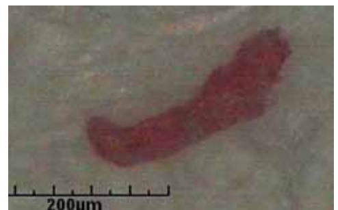
Abb. 35: Nichtmetallischer Partikel, vermutlich Verpackungsmaterial, rosa Schaumstoff'
