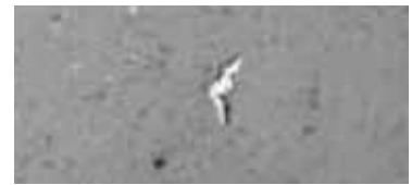
metallischer Partikel 319 \mu\text{m}
