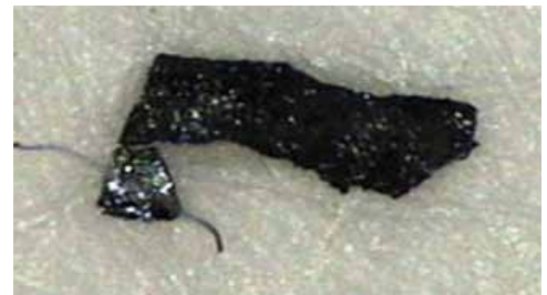
Abb. 34: Nichtmetallischer Partikel, vermutlich Grat oder Kunststoffrest (217 µm)
