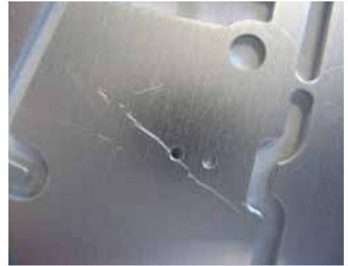
Abb. 67: Beschädigte metallische Versteifung
