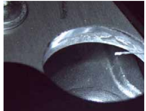
Abb. 69: Stanzreste durch Beizen gelöst
