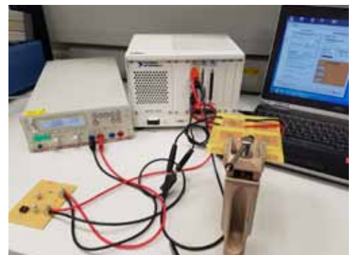
Abb. 92: Automatisierte softwaregestützte Strommessung
