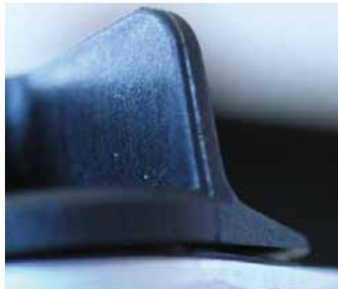
Abb. 70: Kunststoffelement mit Grat
