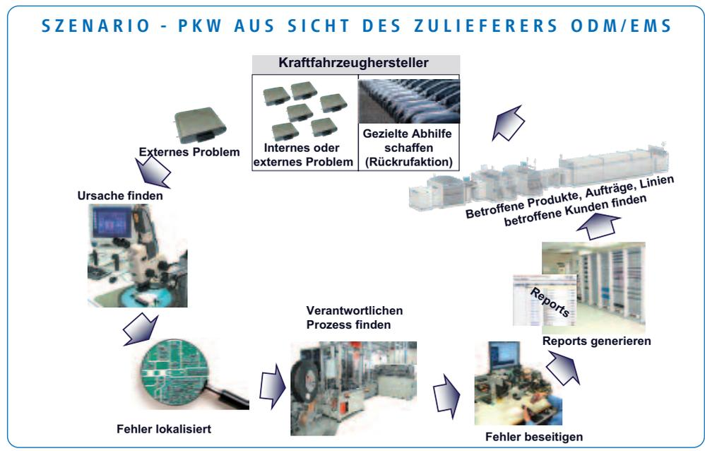
Bild 2.2: Traceability aus Sicht eines Zulieferers
