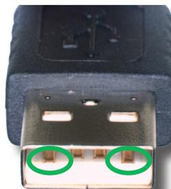
Крайне редко встречаются **блоки управления**, которые благодаря использованию опережающих контактов заземления подготовлены для **горячего подключения**.
