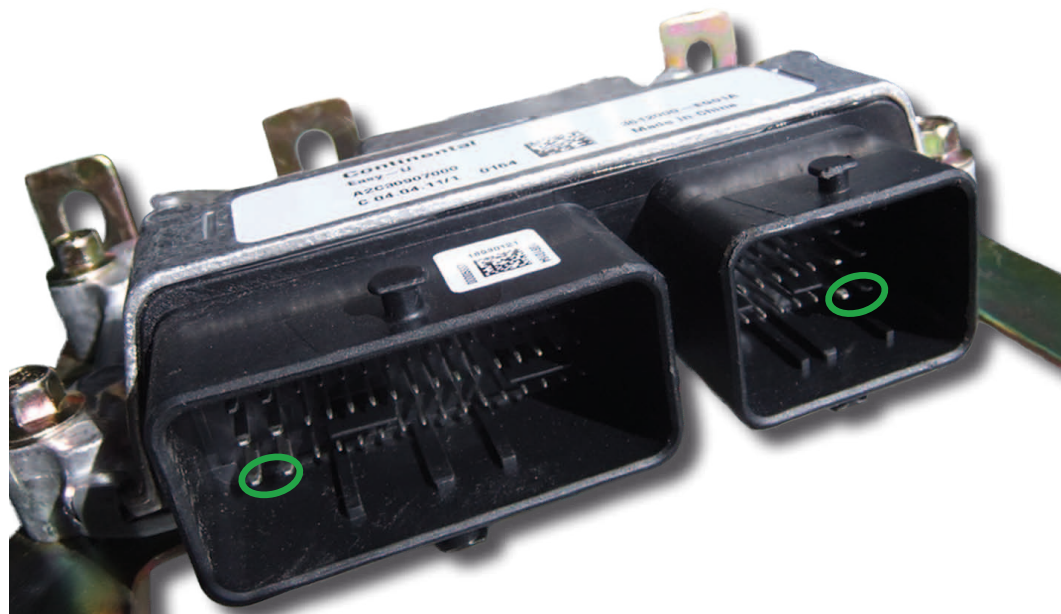
Unité de commande Bosch EDC16 pour Peugeot/Citroën avec contacts de masse à action anticipée
