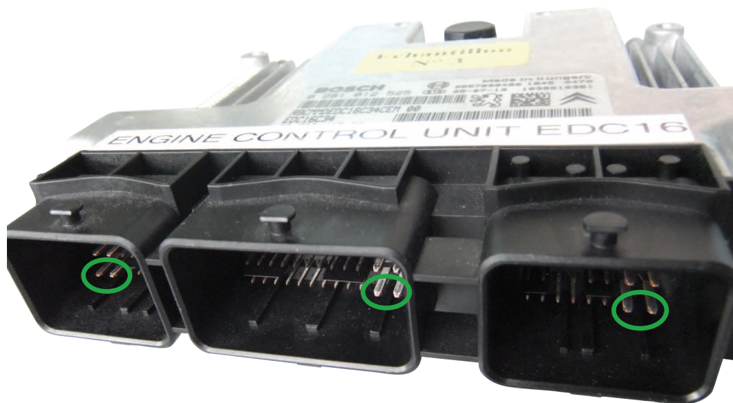
Unité de commande Bosch EDC16 pour Peugeot/Citroën avec contacts de masse à action anticipée
