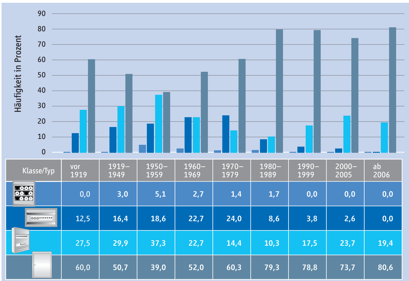
Abb. 6: Stromkreisverteiler nach Gebäudealter (Eigentum, n = 599)
