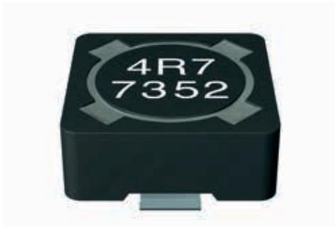
Bild 42: Leistungsinduktivität als Speicherdrossel für kleinere DC/DC-Wandler oder zur Stromglättung in anderen Baugruppen – Quelle: Epcos
