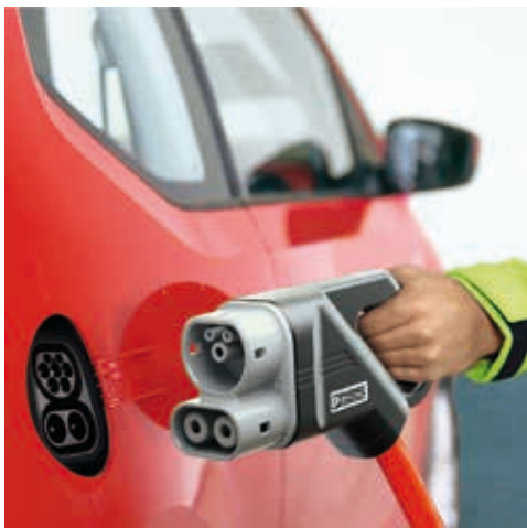
Abb. 93: AC/DC-Ladestecker mit Combined Charging System (CCS) – Quelle: Phoenix Contact
