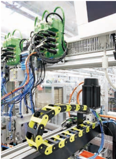
Abb. 51: Sensor-Aktor-Verteiler in der Fertigungsautomation – Quelle: Phoenix Contact
