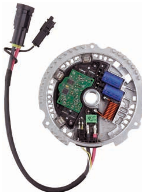
Abb. 43: Steckverbinder und Kontaktelemente an einer Kühlerlüfter-Steuerung für Pkw – Quelle: Lumberg
