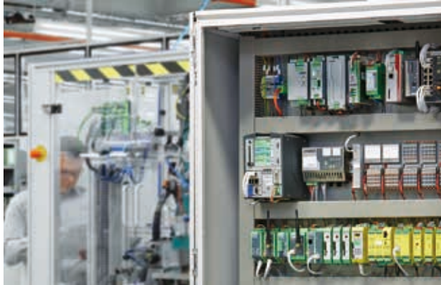
Abb. 54: Maschinensteuerung mit Signal- und Datensteckverbindern – Quelle: Phoenix Contact
