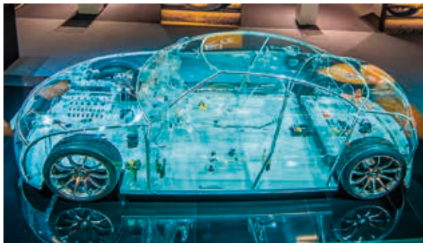
Abb. 85: Vielfalt von elektrischer Verbindungstechnik in einem transparenten Fahrzeug – Quelle: TE Connectivity
