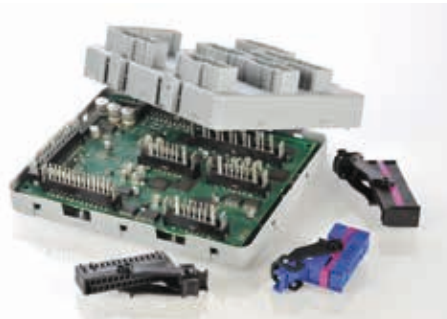
Abb. 87: Bordnetzsteuergerät mit Steckverbindern – Quelle: Lear
