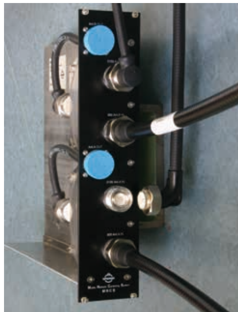
Abb. 80: Genormte koaxiale Steckverbinder Bauform 7-16 zum Anschluss von hochflexiblen Wellmantelkabel für Mobilfunkanwendungen – Quelle: Spinner
