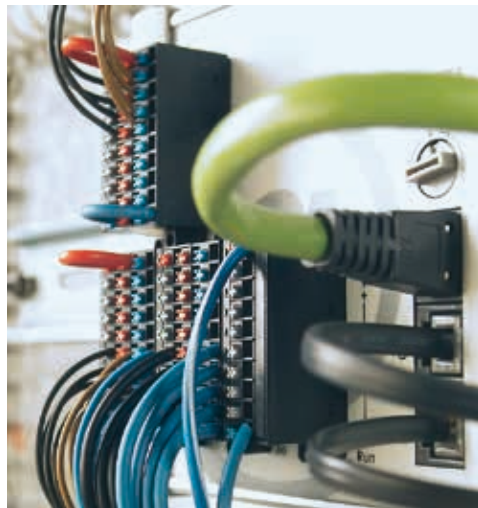
Abb. 55: I/O-Element (Input/Output) mit Sensorsteckverbindern – Quelle: Weidmüller
