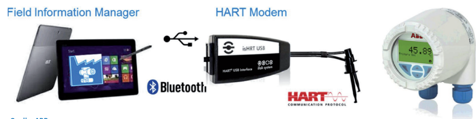
Abb. 7: Field Information Manager mit HART-Modem und Feldgerät
