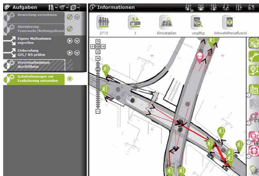
Bild 23: Leitstellenansicht der dynamischen Lenkung
