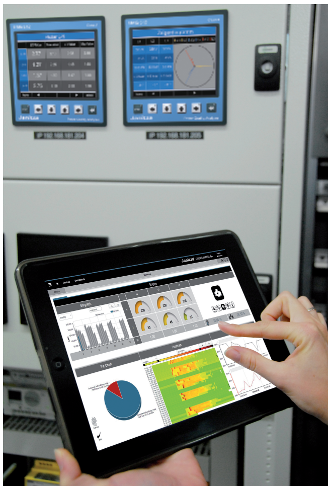
Bild 2: Zugriff vom Smart Devices auf Prozessdaten
