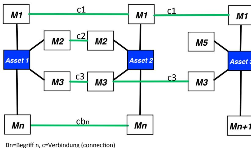
**Bild 12:** In der Informationswelt werden die *Verbindungen der physikalischen Welt* zwischen Assets durch Beziehungen ( $r$ ) zwischen in den Verwaltungsschalen der I4.0-Komponenten abgelegten Merkmalen ( $M$ ) dargestellt
