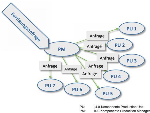
Gemäß Bild 4 nimmt der Production Manager eine Fertigungsanfrage entgegen und prüft auf Basis der in Bild 3, rechte Seite, gezeigten Dienste die Fertigungsmöglichkeiten anhand der Fähigkeiten der im Pool vorhandenen PUs mittels Anfragen an die PUs. Diese Prüfung auf Basis der Angebote der PUs schließt die Verfügbarkeit der PUs und den Preis jedes Fertigungsschritts mit ein, sodass daraus ein Auftragspreis ermittelt werden kann (Bild 5).
