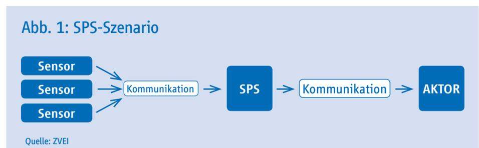
Von den Sensoren werden Messdaten (z. B. Temperatur, Druck oder Füllzustand) erfasst und an die SPS übertragen. Die SPS empfängt die Daten, verarbeitet sie und sendet Steuerbefehle an einen Aktor. Der Aktor (z. B. ein Motor oder eine Pumpe) setzt die Befehle um.
