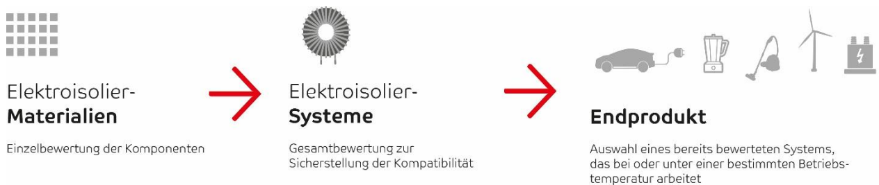
Abbildung 4: Prozessablauf: Vom Material zur Endproduktzulassung, Bildquelle Synflex
