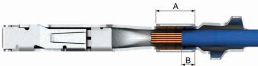
Abbildung PG 60-3: Isolationsendeposition für Fehler „eingecrimpte Isolation“
