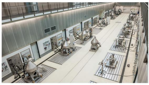
Module, die bereits MTP "sprechen" – so wie beispielsweise diese Zentrifugen – können leicht in Produktionsanlagen implementiert werden. (Quelle: GEA)
