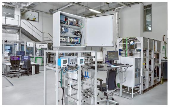
In der NOA-Versuchsanlage bei INVITE wurde nachgewiesen, dass das Online-Condition-Monitoring für PAT-Messgeräte ein lohnender Anwendungsfall für NOA ist. (Quelle: Phoenix Contact)
