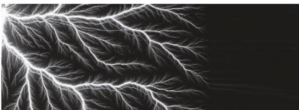
Fig. 8: Ausbildung eines leitfähigen Pfades auf oder in Isolationsmaterialien (Quelle: CMC)
