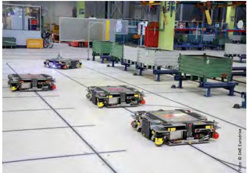
Autonome Logistikkassistenten versorgen die Produktionsinseln im SEW-Werk Graben-Neudorf.
