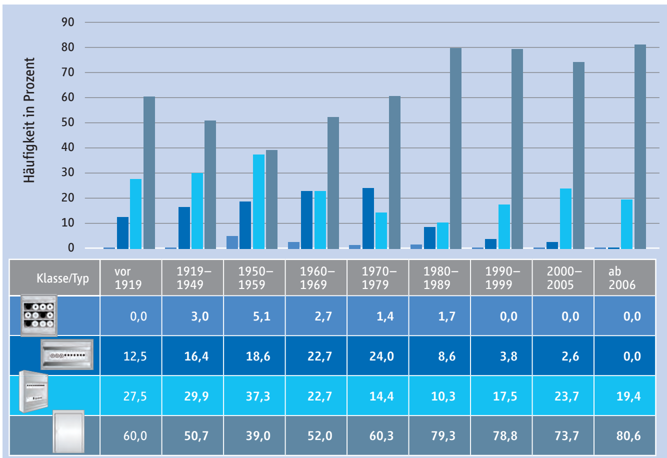
Abb. 6: Stromkreisverteiler nach Gebäudealter (Eigentum, n = 599)
