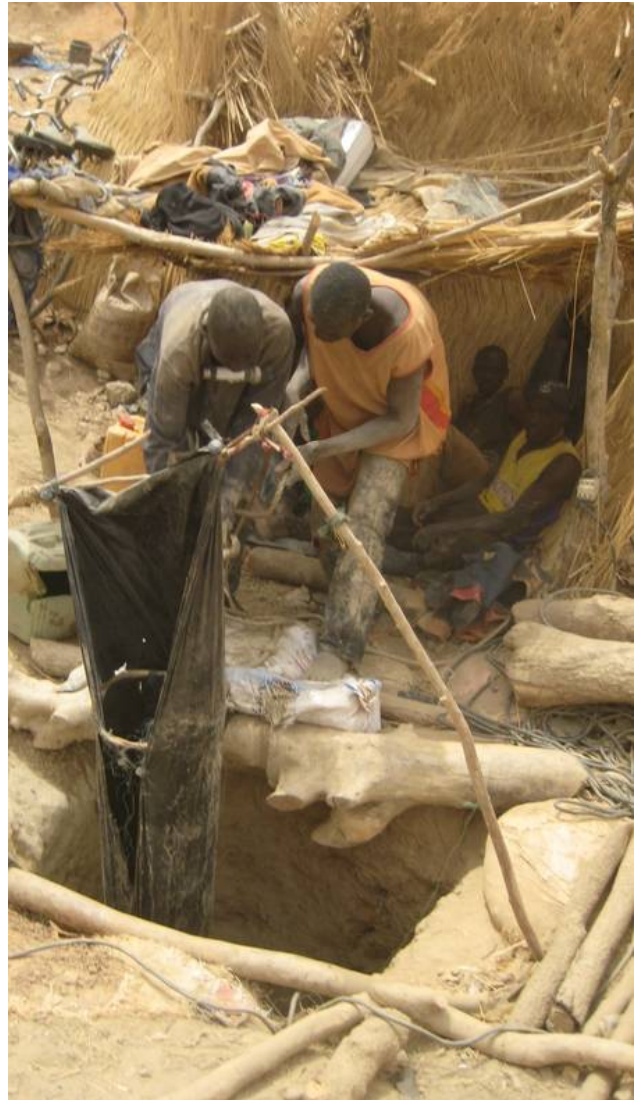
Sauerstoffversorgung im Schacht © Jörg Lange
