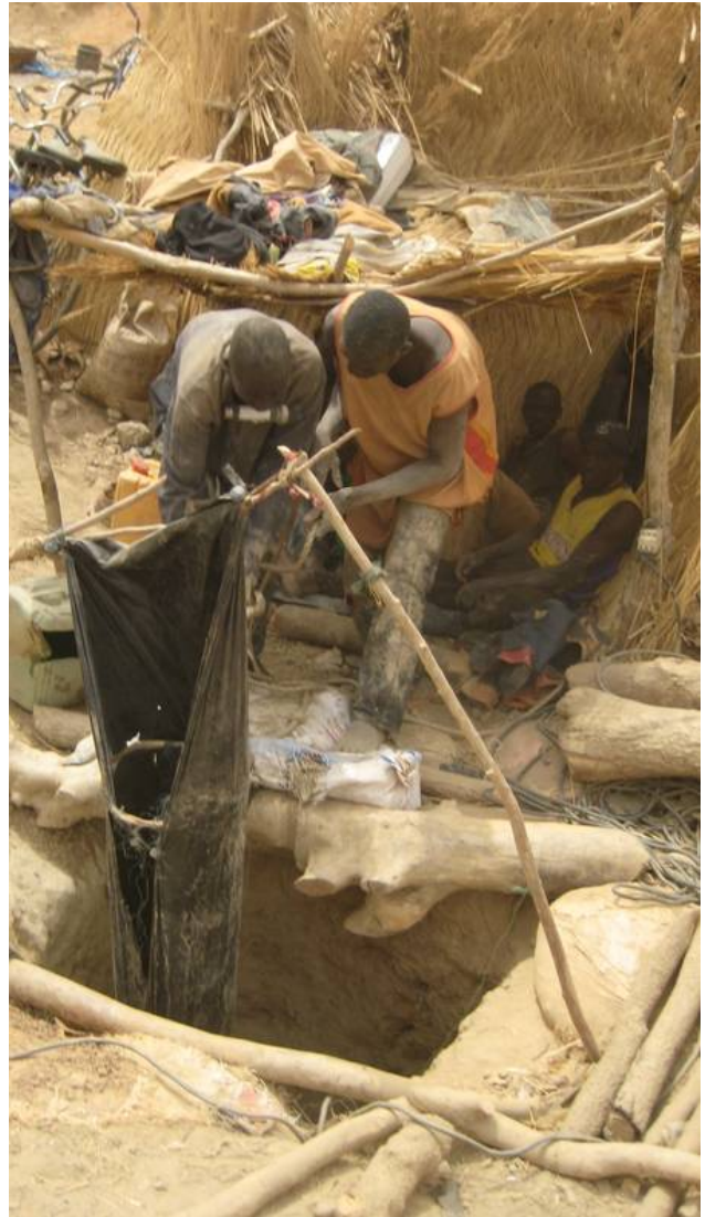
Sauerstoffversorgung im Schacht © Jörg Lange
