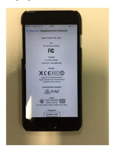
Beispiel: Kennzeichnung beim Mobiltelefon über die elektronische Anzeige
