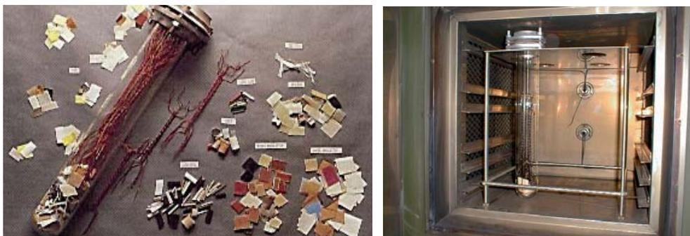
Bild 2: Glaskolben (Sealed Tube) und Wärmeschrank
