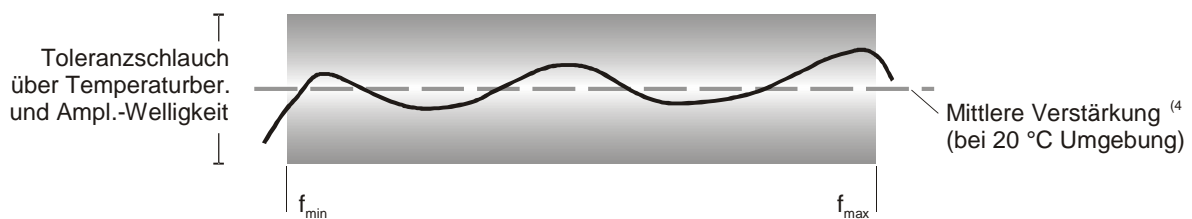
Abb. 1: Verdeutlichung des Toleranzbegriffs (hier bei flachem Frequenzgang) für den Amplitudenverlauf
